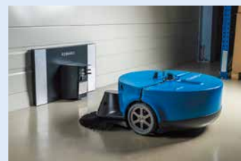
充電ステーション
