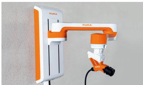
最適なブラシ配置と分かりやすい制御インターフェースを使用して 完全に自動化されたドッキングステーション
