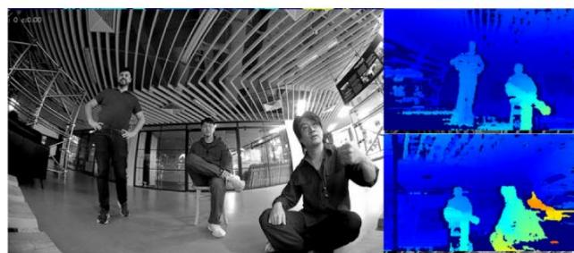
デュアルステレオカメラのセットアップは、180°の3D状況認識を備えた重なり合う深度マップを出力します。ステレオカメラは点群データを提供し、VIO推定によりマッピングが可能になります。DNNアルゴリズムをホストするコンピュータービジョンは、ナビゲーションやアプリケーション用途のために、世界に存在する特徴の認識を可能にします。
